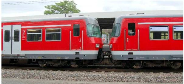
Es genügt daher, 30 Pärchen aus Triebwagen zu bilden, die jeweils an einem Ende einen Führerstand haben. Die anderen 64 Pärchen haben nur einen Triebwagen mit Führerstand. Der andere bekommt stattdessen einen Durchgang zum nächsten Wagen, ein zusätzliches Fahrgastabteil mit 8 Sitzplätzen und einen kleinen Rangierfahrschalter, um das Pärchen in der Werkstatt oder in Abstellgleisen zu bewegen.
