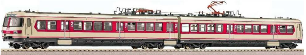
Modell der fiktiven Baureihe 422 für die Citybahn Nürnberg. Die beiden Triebwagen unterscheiden sich nur am Übergang in der Mitte: Der Typ A (links) bietet dort einen Einstiegsraum mit Türen und der Typ C (rechts) Toiletten (mit Milchglasscheiben).
