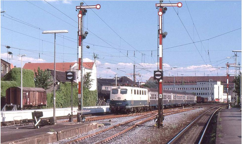
*Im Sommer 1990 hatte der Bahnhof Erlangen noch 30 cm flache Bahnsteige und Formsignale. Günter Hoppe fotografierte 141 019, die mit einem Nahverkehrszug aus Nürnberg auf Gleis 1 einfuhr. Der Güterwagen am linken Bildrand beweist, dass am Ostrand noch das Stumpfgleis lag, auf dem bis 1962 die Züge der Nebenbahn über Neunkirchen am Brand nach Eschenau (an der KBS 893) wendeten.*
