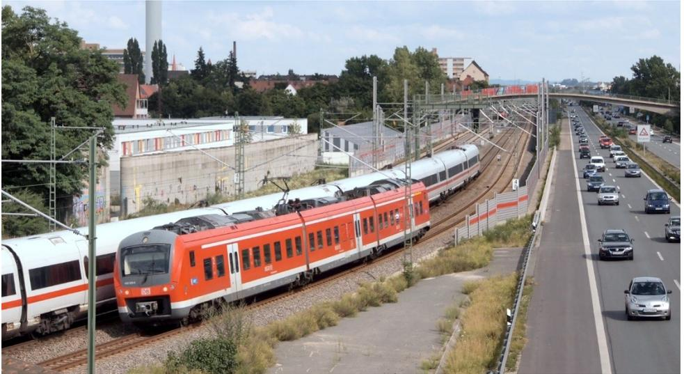
*Blick nach Osten auf die viergleisig ausgebaute Strecke zwischen der Stadtgrenze und Neusünderbühl. Bei **FiT** sähe dieser Bereich genau so aus, die Gleise würden aber anders genutzt: Während in der Realität nur das linke Gleis der S-Bahn im 20- bis 40-Minuten-Takt dient, würde bei **FiT** das verdeckte Gleispaar im 10- bis 20-Minuten-Takt befahren. (Jörg Schäfer, 15.7.2014)*
