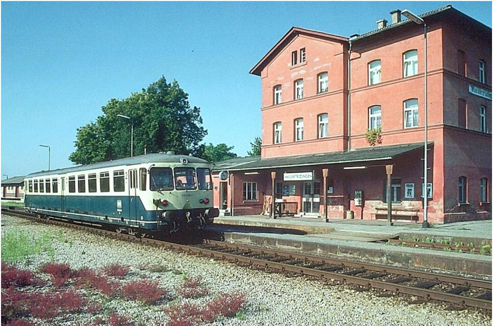
*Die vierachsigen Triebwagen der Baureihe 515 prägten von 1972 bis 1985 das Bild der KBS 887. In Kästen unter dem Fußboden waren Akkumulatoren untergebracht, die bis zu 550 kWh Strom speicherten. Damit kamen die „Akkublitz“ auch ohne Oberleitung über 200 km weit elektrisch voran. Wolfgang Frank fotografierte 515 008 am 19.6.84 beim kurzen Stopp in Wassertrüdingen.*
