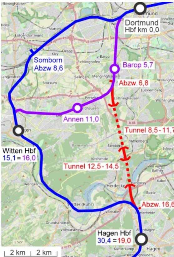
Der **VD-T** hätte diese wichtige Achse schon bis 1993 so ausgebaut, dass ICE 25 Minuten schneller voran kommen:
